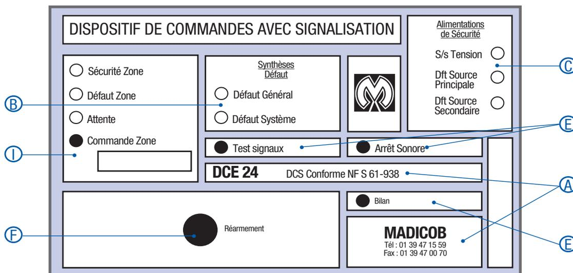
Dispositif de Commande avec Signalisation (D.C.S.)
