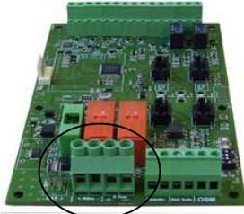
Utiliser un module de surveillance de ligne (MSL ou MSL8) près de chaque DAS (**au maximum à 3 mètres**) et placer une résistance R2 de 3k3 en fin de ligne sur les bornes 3 et 4 du MSL (cf. raccordement du module dans le boîtier)
