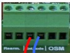
Entrée 24 volts ou 48 Volts à émission ou à rupture venant du DCS ou du CMSI
