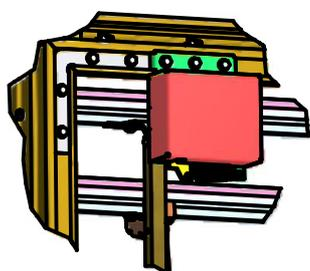
↑ remonter manuellement la barre de liaison jusqu'au réarmement de la ventouse
