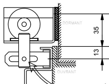
Réglage de la position du pêne en fonction de l'épaisseur du recouvrement du ouvrant.
